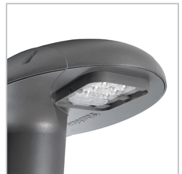
De ProFlex™ optische units zijn 90° gedraaid voor asymmetrische lichtverdelingen.
