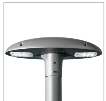
Het armatuur wordt bevestigd op een Ø48-60mm mast met twee M8 schroeven
