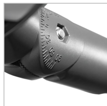
La fixation par rotule, en configuration sommitale ou latérale, autorise une large plage de réglage (180°) pour adapter l'inclinaison.
