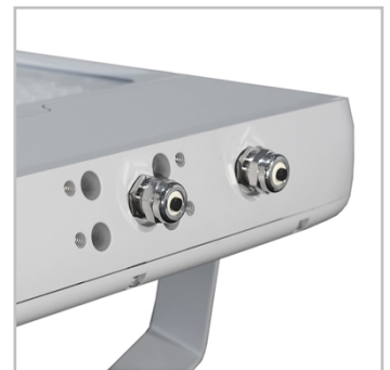
Le projecteur comprend deux presse-étoupes à l'arrière (entrée et sortie) pour une configuration en guirlande. Il est conçu pour être intégré aux systèmes de gestion des bâtiments avec le protocole DALI 2.0 ou 1-10V.
