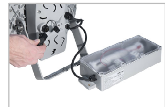
In geval van nood kan een optionele hulpbatterij de INDU BAY GEN3 gedurende 3 uur van stroom voorzien om veiligheidsverlichting te bieden.
