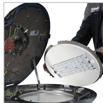
FLEXIA POEME comporte une déconnexion électrique instantanée à l'ouverture et un moteur LED amovible sans outil.
