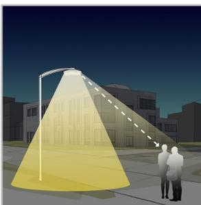
La hauteur d'installation d'un luminaire urbain, par rapport à un éclairage routier, est plus réduite. Dans ce cas, le confort visuel devient un aspect essentiel. Schröder conçoit des optiques et des accessoires permettant de minimiser tout type d'éblouissement (éblouissement distrayant, inconfortable, invalidant et aveuglant). Nos bureaux d'études exploitent un éventail de possibilités afin de trouver les meilleures solutions pour chaque
